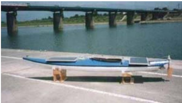
さっちん 全長：3990 mm 全幅：600 mm 推進器：ツシマ 400W プロペラ：50 馬力船外機用
