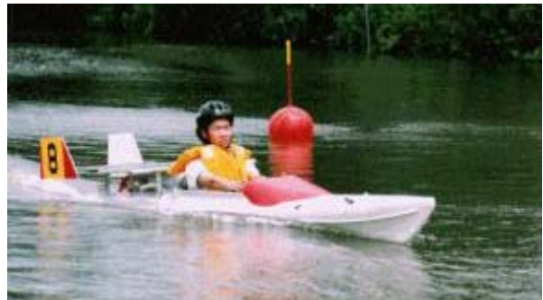
緋炎（ひえん） 全長全長：3990 mm 全幅：500 mm 推進器：特殊電装 450W プロペラ：20 馬力船外機用
