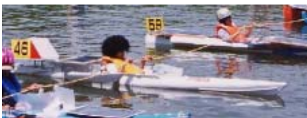
緋炎改(ひえん・かい) 全長全長: 3990 mm 全幅: 500 mm 1100 mm (補助浮体を含む) 推進器: 特殊電装 450W プロペラ: 20馬力船外機用 ・補助浮体増設 ・空気吸いこみ防止板増設
