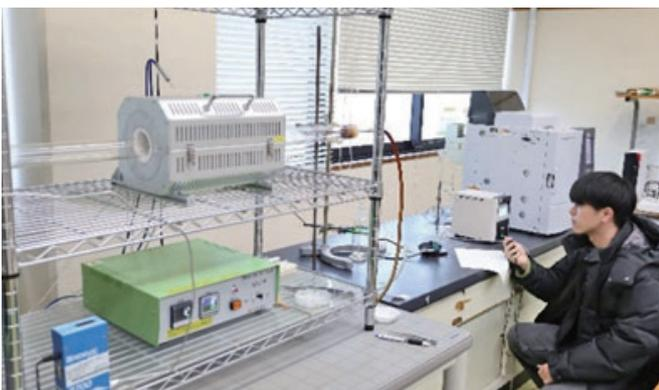
電気炉を使用した脱離ガス分析
