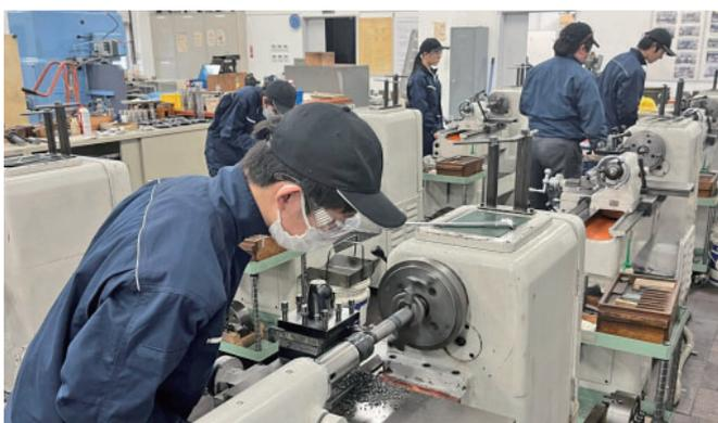
材料加工実習（旋盤加工）
