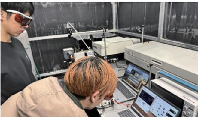
レーザービームプロファイル測定実験
