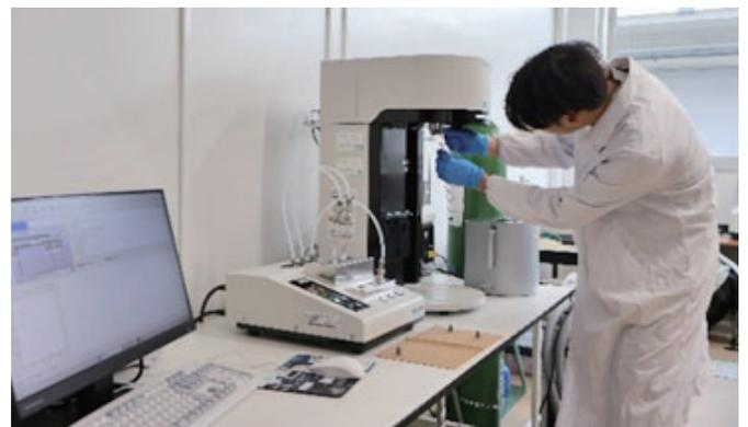
合成したサンプルのガス吸着測定
